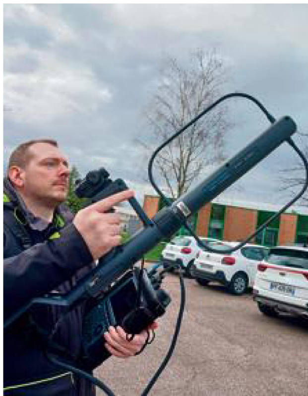
A Nancy, le 23 janvier, les agents auscultent l'environnement radioélectrique. A gauche, ils déploient un mât télescopique afin d'affiner la traque du brouilleur d'ondes. A droite, un récepteur les guide jusqu'au brouilleur. ANFR
